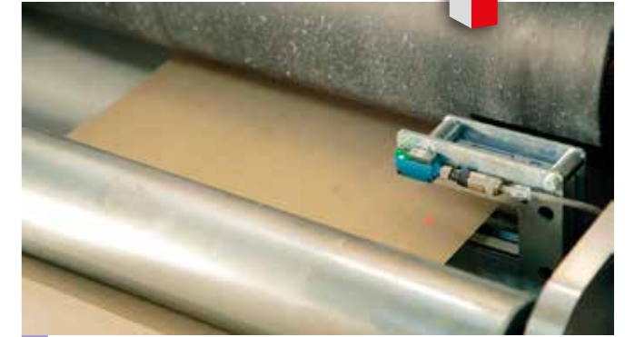
6 Sistema di allineamento laterale automatico tramite sensore a ultrasuoni. Automatic lateral alignment system by ultrasonic sensor.
