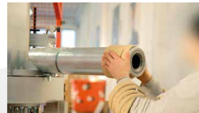
11 Carico delle nuove anime per prossimo taglio. Loading of the new souls for next cut.
