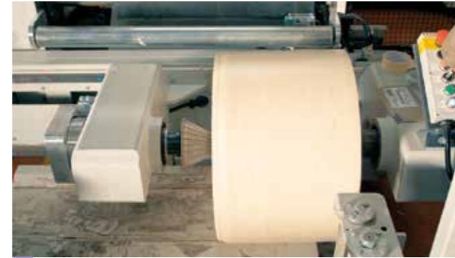
5 Sistema automatico di riconoscimento della pressione per coni di blocco. Automatic pressure detection system for block cones.
