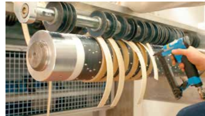
7 Blocco manuale dei bordi sull'anima di cartone. Manual blocking of the edges on the cardboard core.
