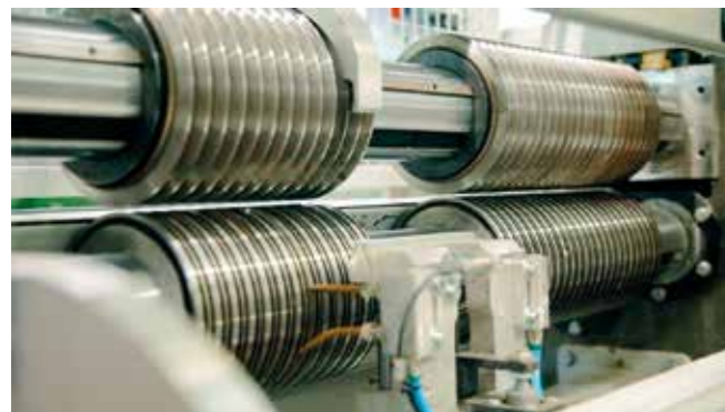
3 Posizionamento automatico e pulizia delle lame e gestione motorizzata dell'intersezione tra di loro. Automatic positioning and cleaning of the blades and motorized management of the intersection between them.
